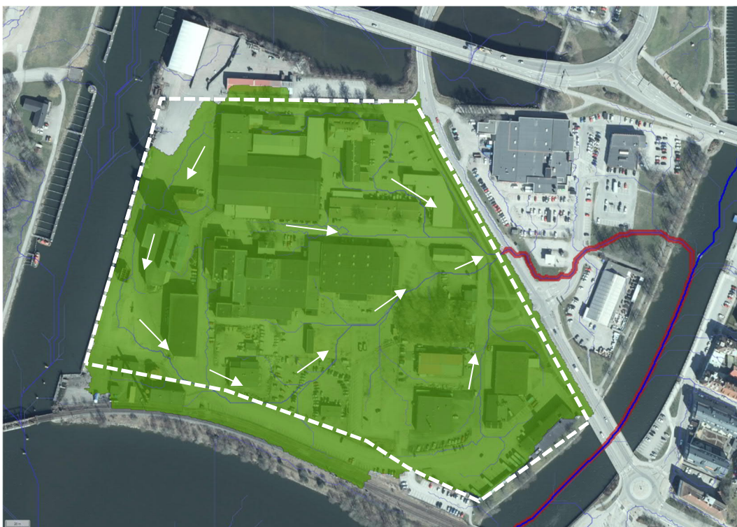
Figur 3 Avrinningsområde med ytliga avrinningsvägar. Avrinningsområdet avser det gröna området och de ytliga avrinningsvägarna är markerade med blåa linjer inom planområdet. Röd linje visar den ytliga avrinningsvägen utanför planområdesgränsen. Planområdets ungefärliga gräns är markerad med vitstreckad linje. Vita pilar förtydligar riktningen på de ytliga flödesvägarna (SCALGO Live, september 2021).
